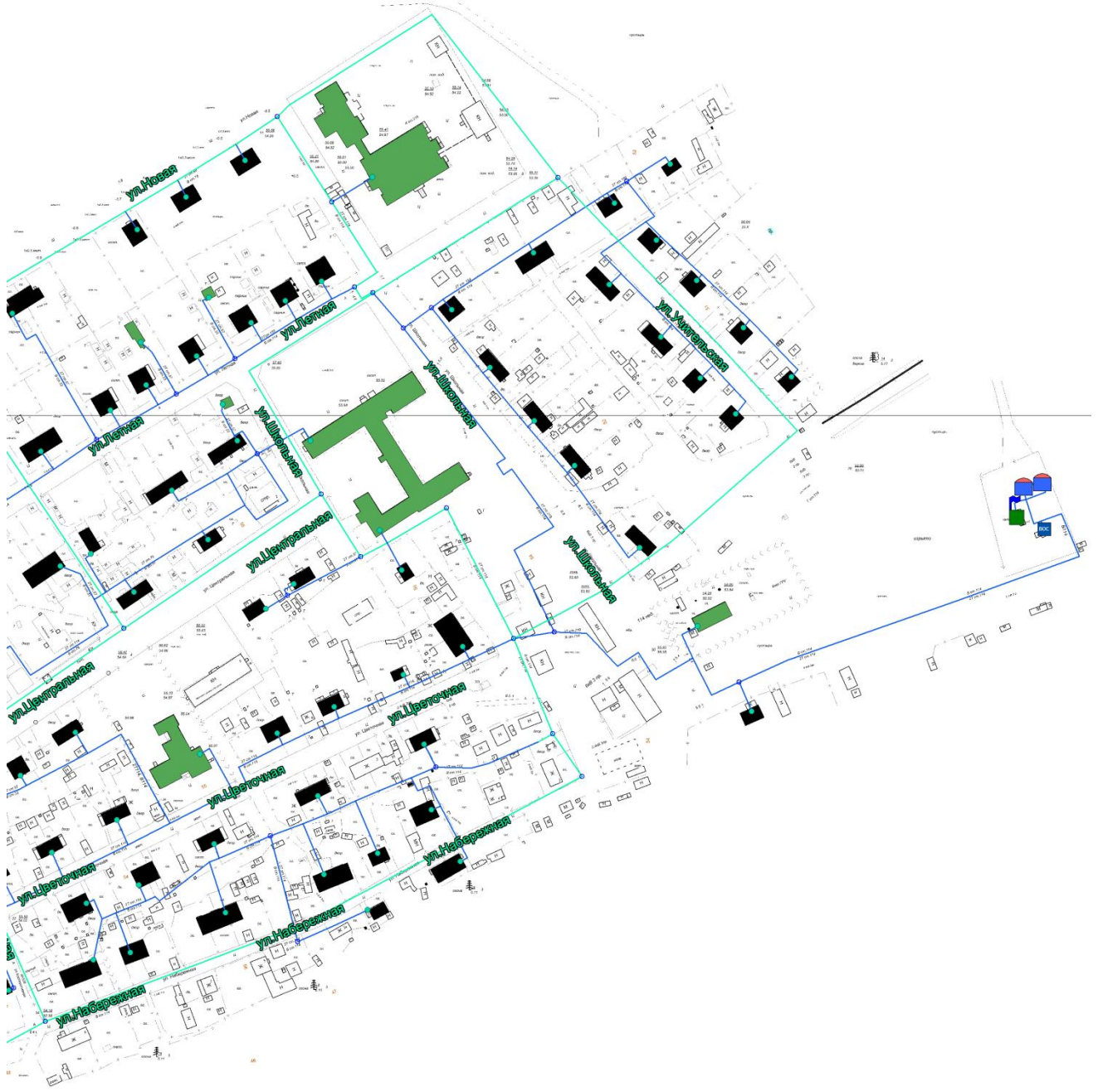
Рисунок 1.11. Перспективная схема водоснабжения с Охтеурье по ул. Центральной, Летней, Цветочной, Набережной, Новой, Школьной, Учительской.
